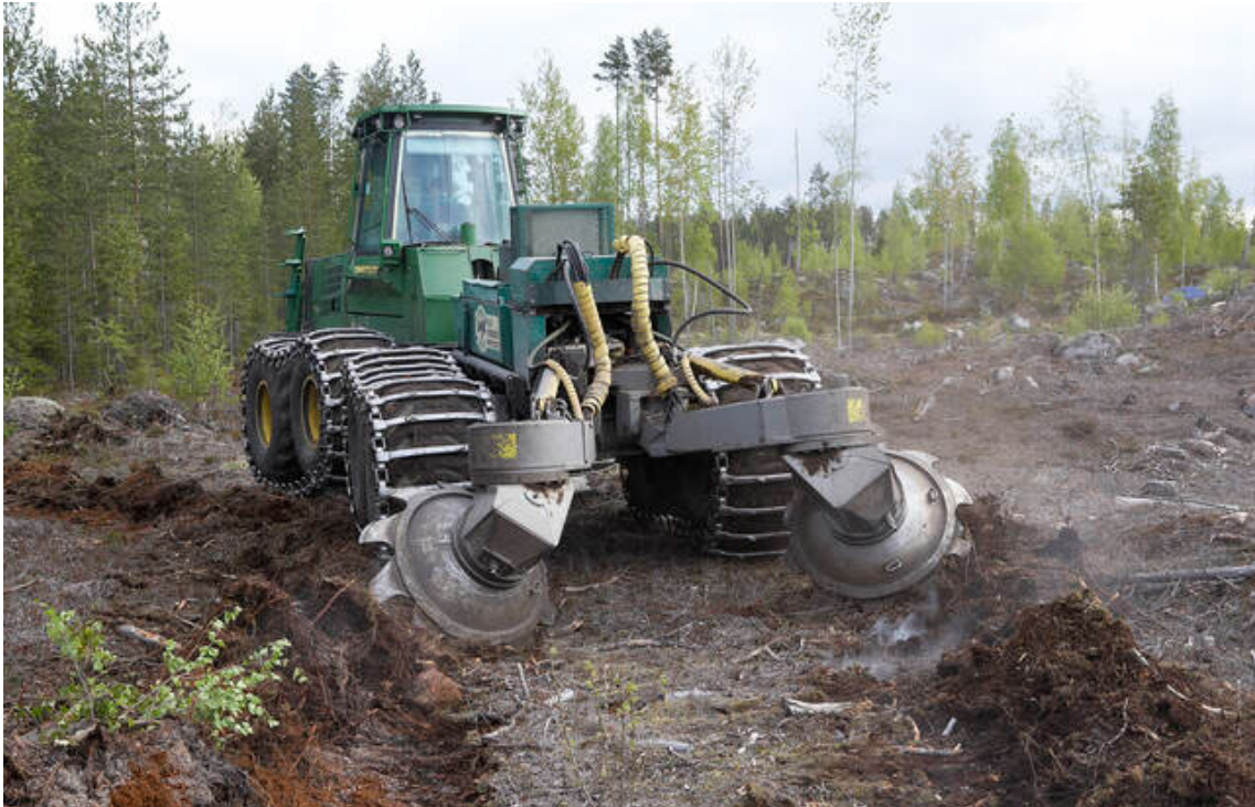
Kylvötoistä merkittävä osa tehdään nykyisin maanmuokkauksen yhteydessä konekylvönä. Kuva: Erkki Oksanen, metsänhoidon suositukset
